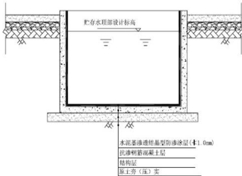
图 8.2-3 污水储池防渗示意图
