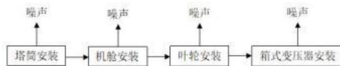
图 2-2 风电机组安装工艺流程及产污节点图
